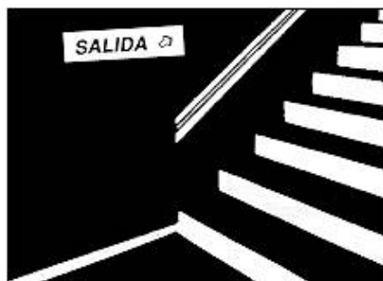
Fig. 16: Recubrimiento de contrahuellas con pintura fotoluminiscente
